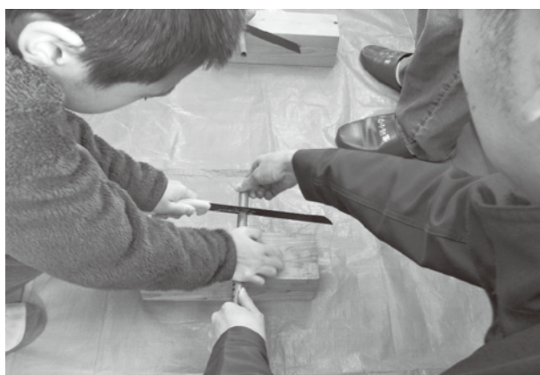
のこぎり塩ビ管を切っている様子
